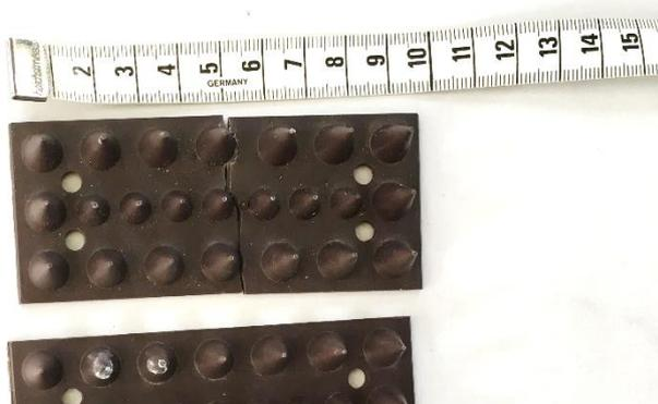
Es handelt sich um Stahlplatten ca. 10 x 5 cm mit 3 Reihen spitzen Kegeln, die sich in die Reifen bohren und zu Schäden führen.
